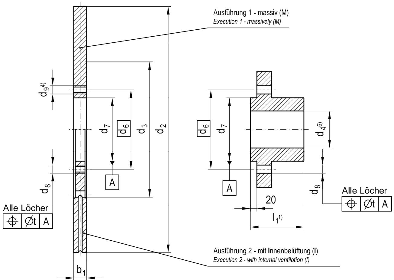
**Bremsscheibe mit Nabe nach DIN 15 431**
